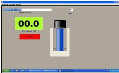
**IMADŁO** – Software für die genaue Druckmessung von Pumpen Düsen. Das Messelement muss auf einer speziellen Spannvorrichtung befestigt werden. Die Test Pläne für UI/Denso/Siemens sind inbegriffen.
