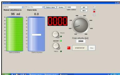
**TCR990** – Software für die steuerung der Pumpen Düse System auf Prüfständen. Die Software beinhaltet BIP prüfung funktion und Test pläne für PKW und LKW.
