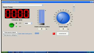
**TCR3** – Steuerungsmodul : Erlaubt die steuerung aller sorten von Common Rail Pumpen in modernen Einspritz systemen. Das Modul hatt eine Funktion mit der Sie den DRV Ventil Steuern können. Sie können mit dem Gerät auch Induktionsmessungen durchführen.
