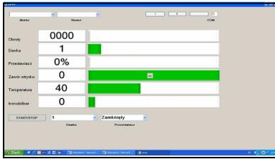
**VP44** – Modul und Software: sie erlaubt die Steuerung der Pumpen VP 37 und VP 44. Sie können damit: die Dosis Steuern, Imo zurücksetzen, Temperatur Vorschauen, CAN Übertragung steuern , Sperrung und Delta-FI.
