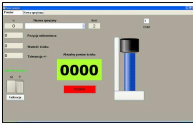
**BIP** – Steuerungsmodul zu bestimmung der Verzögerung (BIP) des Pumpen Düse Systems für PKW und LKW. Sie können das Gerät auf einer Spannvorrichtung benutzen so wie auf Prüfständen. Die Software beinhaltet Test Pläne für PKW und LKW.
