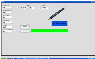
**IMA Delphi** – Software für die Codierung der Delphi Injectoren- Die Codierung besteht aus Angaben der Werte von den Prüfgeräten z.B. EPS 205 , EPS 708 , Zapp Cru 2.
